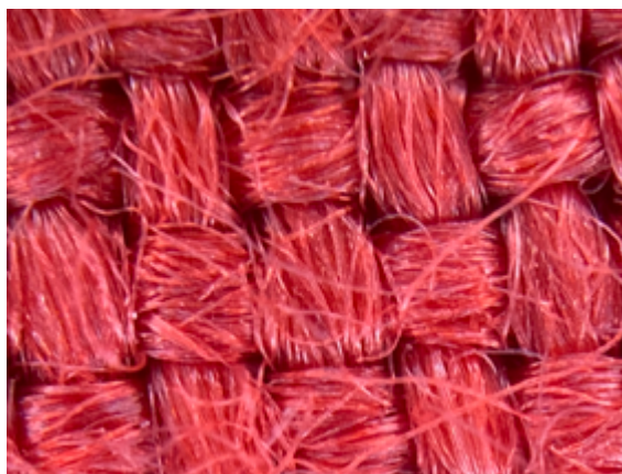
Fig. 9 | Después del proceso de limpieza con bicarbonato de sodio (Imagen propia).
